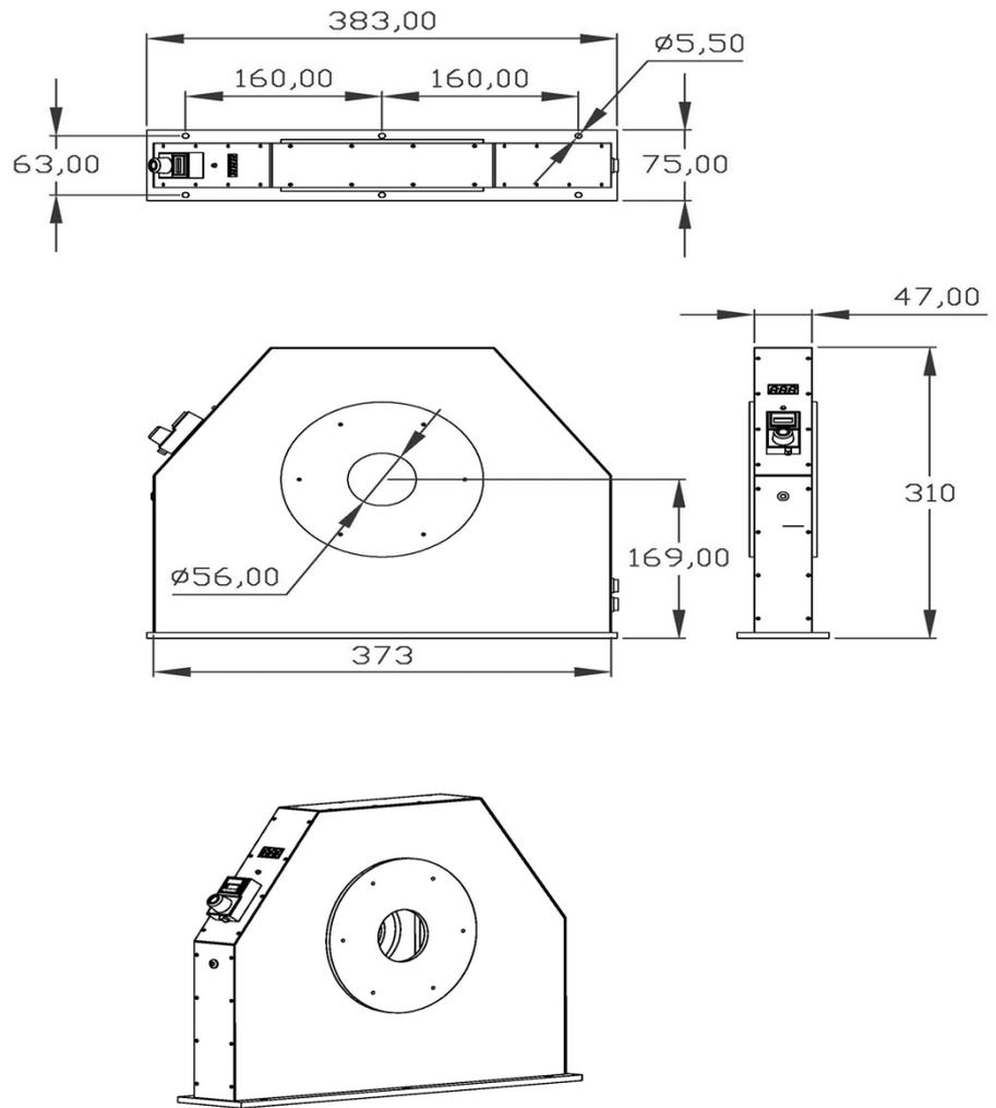
⑥ FK-2P10 (電源カバー) : INPUT : AC220V OUTPUT : DC+/-15V
